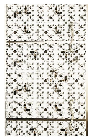
La scheda elettronica DDS1139-01 è sostanzialmente un pannello a matrice di LED RGB 16x16 (256 LED): le dimensioni nominali sono 247 x 247mm mentre il passo dei LED è di 15,94mm.
