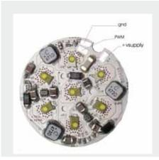
LE.450 Ligth engine, modulo con biadesivo da dissipare su apposito alluminio, e pads di saldatura cavetti di alimentazione e segnale di PWM.
