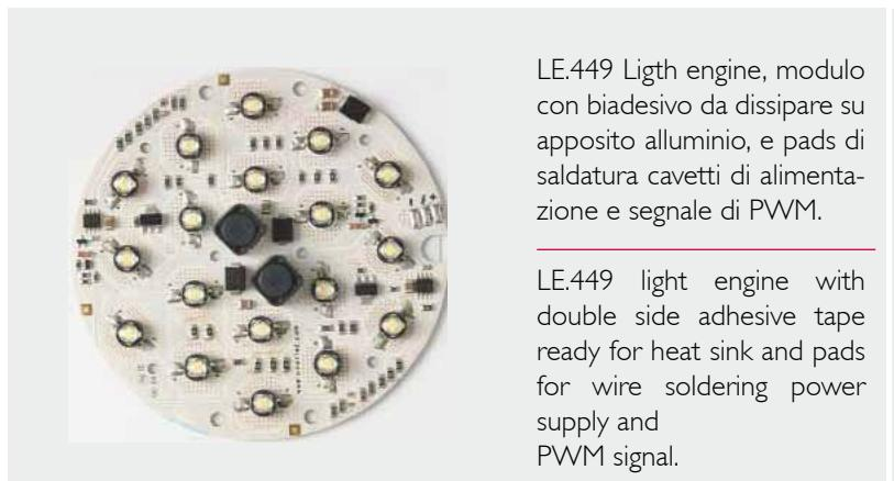
LE.449 Light engine, modulo con biadesivo da dissipare su apposito alluminio, e pads di saldatura cavetti di alimentazione e segnale di PWM.
