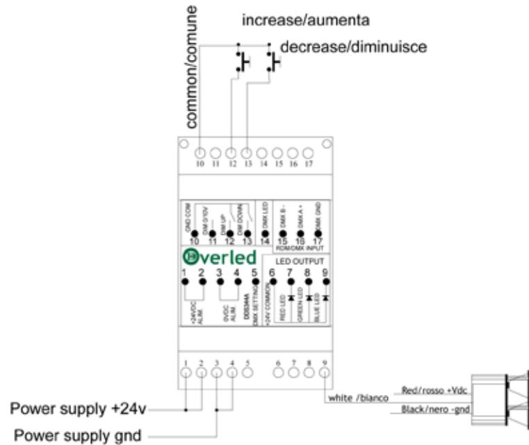
Applicazione di lamp.434 con dimmer digitale DDS.344A controllato da pulsanti per aumenta diminuisci, il terzo filo bianco va collegato al morsetto numero 9 del modulo di controllo, mentre il faretto va alimentato a 24vdc.
