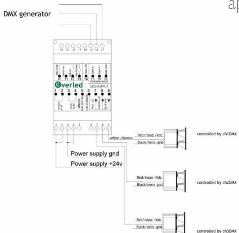
Applicazione di lamp.434 con dimmer digitale DDS.344A controllato da DMX per aumenta diminuisci intensità, il terzo filo bianco va collegato al morsetto numero 9,8 o 7 del modulo di controllo, mentre il faretto va sempre alimentato a 24vdc.
