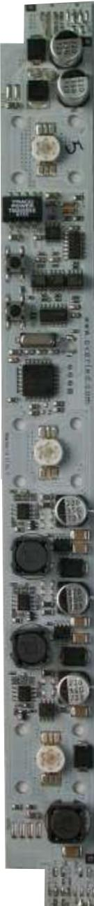
LAMP387 Modulo interfaccibile in DMX/RDM con 3 led di potenza a bordo, da 4,8w alimentazione 24vdc.
