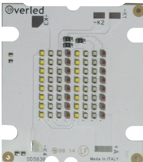
Lamp.636 modulo led COB, CHIP ON BOARD customizzabile a specifica del cliente, questo modulo monta led Luxeon Z per un totale di 64, divisi in 4 sezioni da 16 led ciascuna, permette di gestire RGBW, oppure 4 bianchi diversi o qualsiasi tipo di colore disponibile da catalogo Luxeon Z. Le dimensioni del modulo permettono l'utilizzo di ottiche e zoccoli standard di LEDIL.
