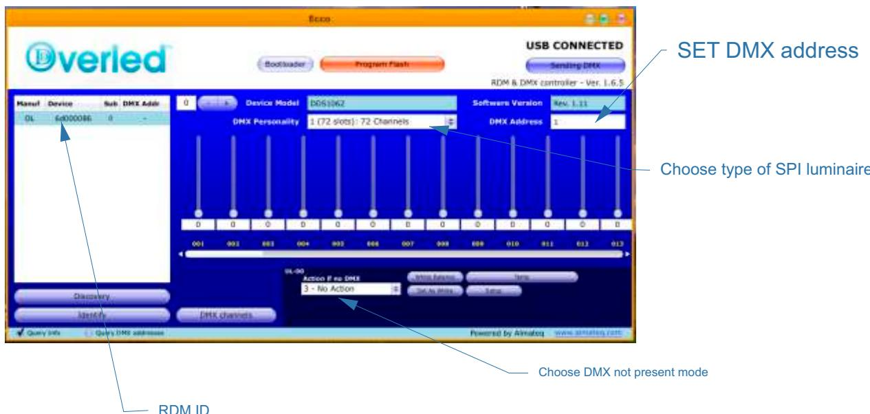
Utilizzando RDM è possibile selezionare il tipo di lampada SPI da utilizzare, l'indirizzo DMX, e cosa il converter deve eseguire in caso non ci sia il dmx , tutto con il menu a tendina poi si selezione l'opzione, in figura uno screen shot con nostro DMX/RDM Ecco, disponibile il software gratuito e le varie interfacce Hardware sul nostro WEB. Sono disponibili i cursori per selezionare il canale desiderato e accendere i pixel della lampada SPI.
