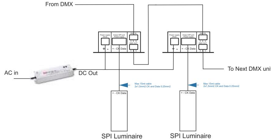
E' possibile collegare più di 32 unità DMX SPI converter, selezionando al modalità Buffer mode, automaticamente l'usicta riampifica il segnale DMX ad altre unità, si raccomanda l'uso di cavo DMX bilanciato e del terminatore a fine linea DMX.
